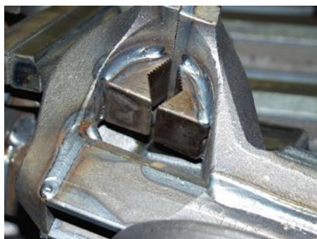
Фото 4: Высокое и стабильное качество сварных швов сокращает длительность доработки и затраты на нее перед процессом лакировки.
