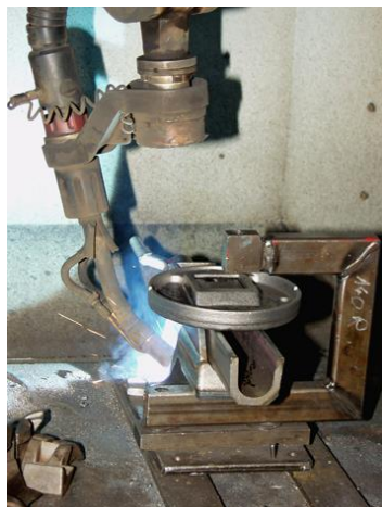
Фото 3: Шарнирный 6-осевой робот приваривает губки к предварительно подготовленной передней части тисков.
