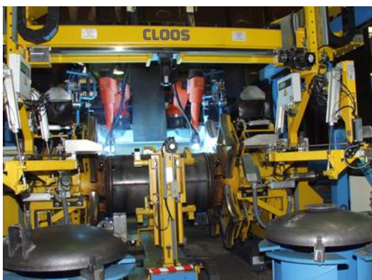
Фото 1: Два сварочных робота QIROX® выполняют параллельную сварку крышки и днища со стенками резервуара для жидкости компании BOSCH.
