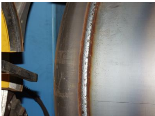
Фото 5: Таких равномерных качественных швов добивается компания Bosch Thermotechnik в процессе однодуговой MAG-сварки.
