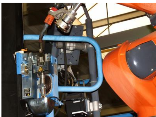
Фото 7: С помощью встроенной станции очистки сварочных горелок роботизированная установка в автоматическом режиме поддерживает газовые сопла в чистоте: Сварочная проволока обрезается. Все процессы выполняются параллельно загрузке и разгрузке устройства.
