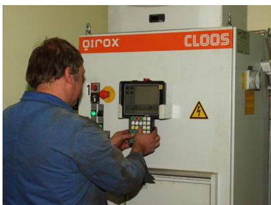
Фото 6: Посредством съемного программатора (PHG) с большими клавишами и дисплеем осуществляется упорядоченное и простое управление обоими роботами QIROX®. Лазерные автономные датчики ICSE-LD также программируются и визуализируются посредством программатора.
