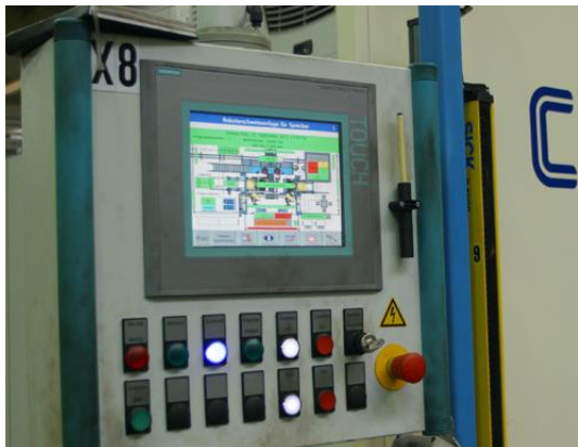
Фото 8: Система управления установкой размещена в этом компактном корпусе с сенсорным экраном. Все циклы визуализированы.
