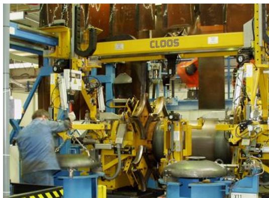
Фото 2: В то время как оператор устанавливает новые крышку и днище, роботы QIROX® затрачивают всего лишь 6 минут на сварку резервуара для горячей воды.
