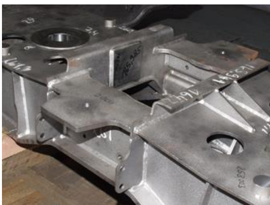
Фото 1: На современных поворотных шасси компании SMW выполняются от 60 до 150 метров сварных швов, вес шасси может составлять от 800 до 1000 кг.
