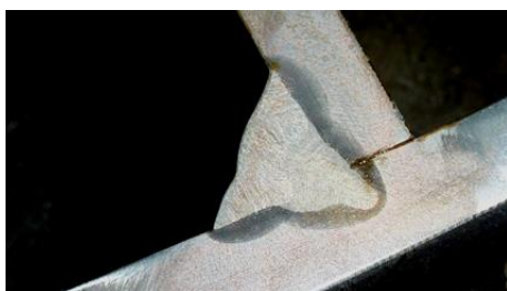
Фото 3: Высокопроизводительный процесс Rapid Weld: Оптимальное проплавление до глубины корня, на фото изображен угловой шов.
